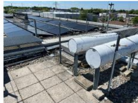
Bild 5: Links: Weiß lackierte Ummantungsbleche ab April 2024 Rechts: Heizmatten auf dem Prüfrohr mit intermittierender Regelung auf 100 °C ab Mai 2025
