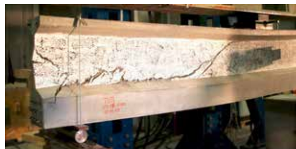
Abb. 4: Kritischer Schubriss am Teilsystemträger VG60-V1
