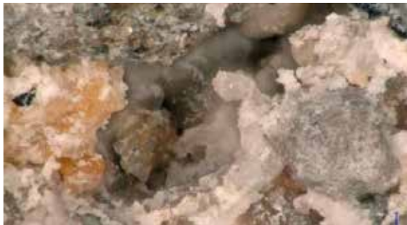
Abb. 5: mikroskopische Untersuchung von Gesteinsbruchstück mit anhaftendem, von den Bakterien gebildeten Calciumcarbonat (weiße Kristalle zwischen den Gesteinskörnern). 100-fache Vergrößerung
