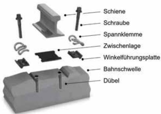
Abb. 1: Schematische Explosionsdarstellung der Elemente einer vorgespannten Betonbahnschwelle
