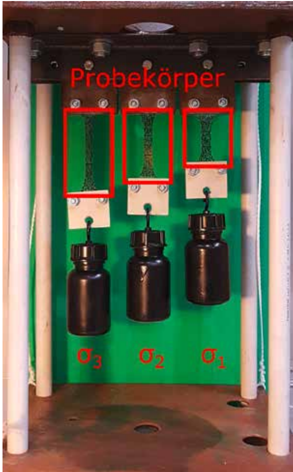
Abb. 3: Versuchsapparatur mit Folien bei laufendem Versuch
