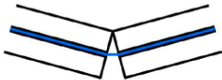
Abb. 1: freiliegende Glaszwischenschichtfolie bei gebrochenem VSG
