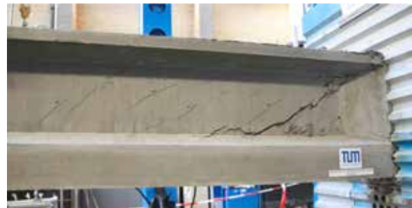
Abb. 3: Kritischer Schubriss am Teilsystemträger VT60-V3
