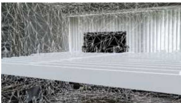
Abbildung 17: Screenshot HoloLens: Kontrollplatte sollte sich exakt in der Ecke befinden
