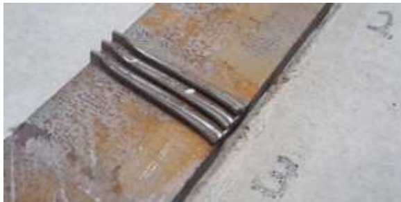
Abb. 4: Abgescherte Stahlzähne unter \alpha = 30^\circ
