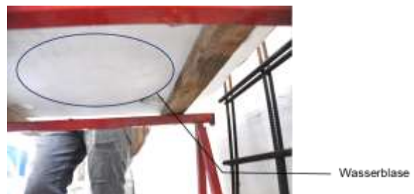
Abb. 4: Probekörper mit Wasserblase nach Druckbeaufschlagung
