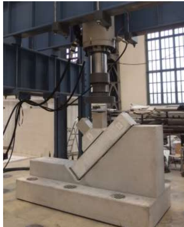
Abb. 9: Fachwerkknott im Maßstab 1:1
