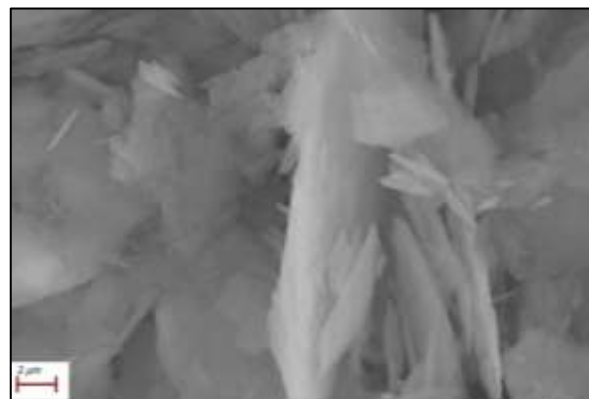
Abbildung 10: Muskovit im Rohzustand unter dem REM bei 10.000-facher Vergrößerung
