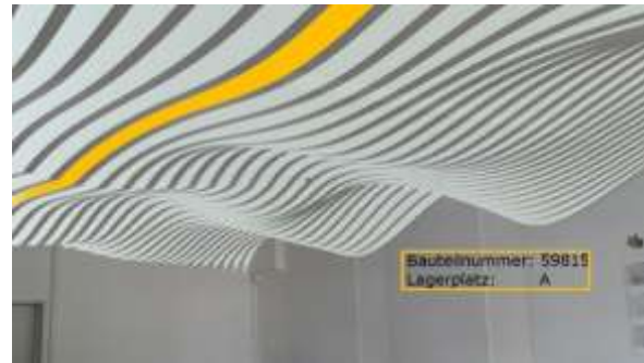
Abbildung 18: Screenshot HoloLens, bearbeitet: Beispiel für eingeblendete Informationen mit der HoloLens (5)
