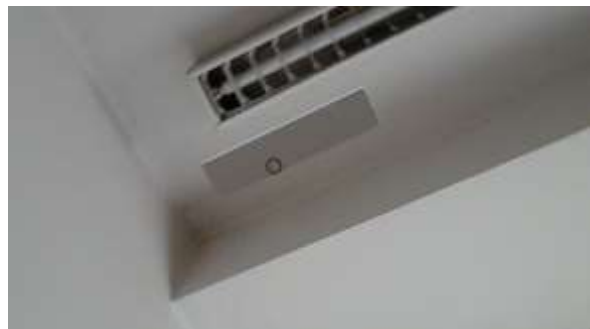
Abbildung 17: Screenshot HoloLens: Kontrollplatte sollte sich exakt in der Ecke befinden
