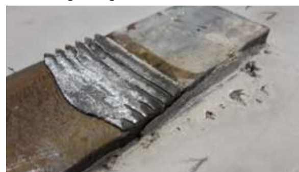
Abb. 3: Verformte Stahlzähne unter \alpha = 70^\circ
