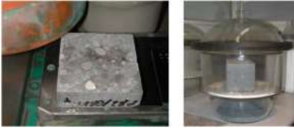
Abb. 2: Innenfläche eines Mikrorissprobekörpers beim Abschleifen in der Nassschleifmaschine (links); Trocknung der geschliffenen Mikrorissprobekörper im Exsikkator über Silikagel (rechts) [1]
