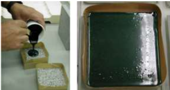
Abb. 3: Vergießen der Mikrorissprobekörper mit eingefärbtem Gießharz (links), vergossener Mikrorissprobekörper bei der Trocknung (rechts) [1]
