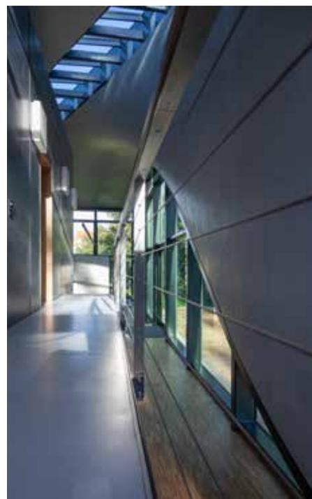
Ende September 2022 wurde das weltweit erste Gebäude aus Carbonbeton „CUBE“ auf dem Gelände der TU Dresden eröffnet. Gebäudehülle und Fundament wurden aus Beton mit einer Bewehrung aus Carbonfasern errichtet, die im Unterschied zur Stahlbewehrung viel leichter, flexibler formbar sowie hoch belastbar sind und filigranere Bauteile ermöglichen. So wird Material (50 % weniger) und letztlich CO<sub>2</sub> (70 % weniger) eingespart.
