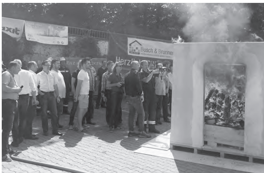
Messung der äußeren Oberflächentemperatur durch die freiwillige Feuerwehr Erlangen
