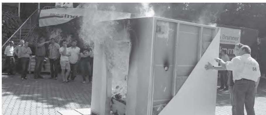
Nach 40 Minuten Feuersbrunst beträgt die Innentemperatur 640°C. Außen ist die Brandbox mit 35°C lediglich angenehm warm.
