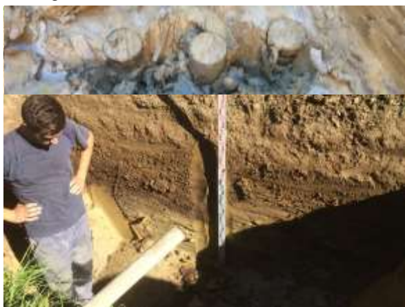
Abb. 1: Baggerschurf und Ausstechzylinder Erkundungsstufe 2
