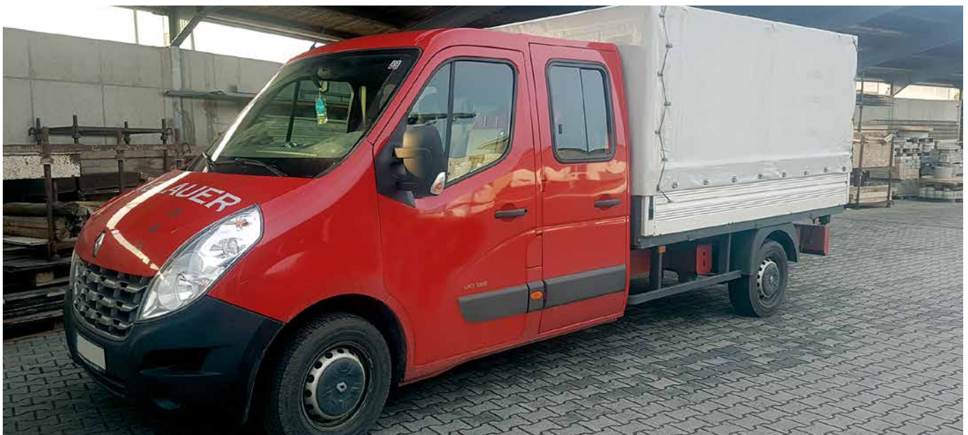
Fahrzeuge mit drei bis acht Sitzplätzen außer dem Fahrersitz, die der Klasse N1 entsprechen (Fahrzeuge zur Güterbeförderung mit einer zulässigen Gesamtmasse bis zu 3,5 t) gelten nach der neuen Einstufung als Personenkraftwagen.
