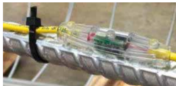
Abb. 2: An Bewehrung befestigter Temperatursensor [5]
