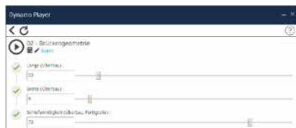
Abb. 1: Steuermaske der globalen Parameter, hier: 02 – Brückengeometrie im Add-In Dynamo Player
