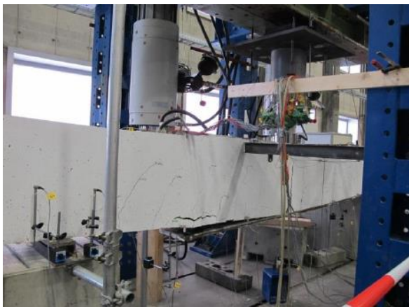
Abb. 3: Versagen des Trägers im Versuch
