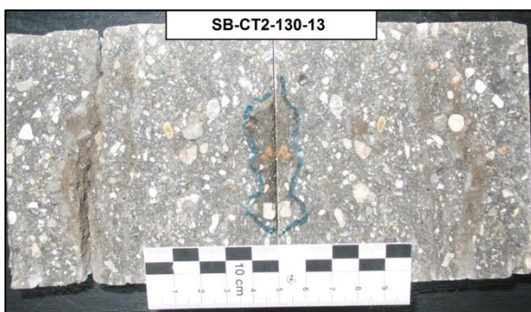
Abbildung 4 - Wassereindringtiefe bei Spritzbeton mit 25%igem Anteil an Calcinierten Tonen
