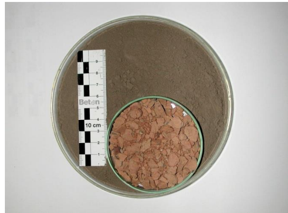
Abb. 1: Calciniertes Ton und Rohgranalien nach dem Calciniierungsprozess
